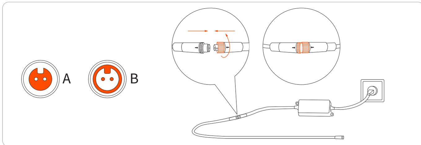
2. Collega il cavo di alimentazione elettrica all'interfaccia di alimentazione. Girare i dadi finché non sono bloccati l'uno nell'altro.
