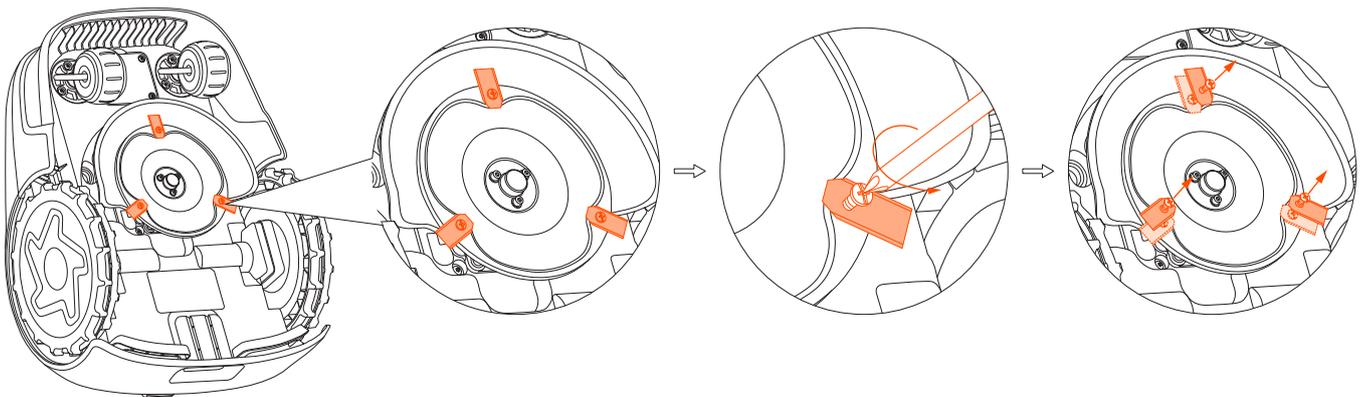
5 Fissa le nuove lame e viti (Coppia: 1 Nm). Assicurati che le lame possano ruotare liberamente.
