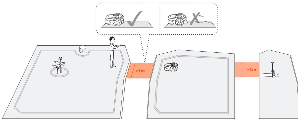
È possibile creare un canale per collegare due zone separate o per collegare il bordo di un prato alla base di ricarica.
