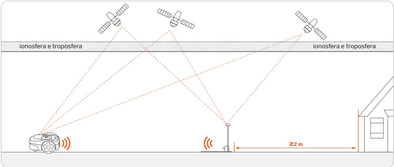
Sistema di localizzazione a fusione esatta (Exact Fusion Locating System EFLS) è l'esclusiva tecnologia di localizzazione ad alta precisione di Navimow. Basata sul posizionamento satellitare, la tecnologia EFLS integra vari dati dei sensori per migliorare la precisione di posizionamento e la tolleranza agli errori attraverso la fusione di algoritmi.
