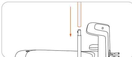
5 Collega l'antenna GNSS alla base di ricarica. Se il cavo non è abbastanza lungo, è possibile acquistare altri cavi di prolunga per l'antenna e utilizzare al massimo 3 cavi per estendere la lunghezza totale fino a 30 m (98.4 piedi).
